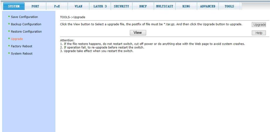
На данной странице WEB интерфейса находится инструмент для обновления прошивки коммутатора из файла.
