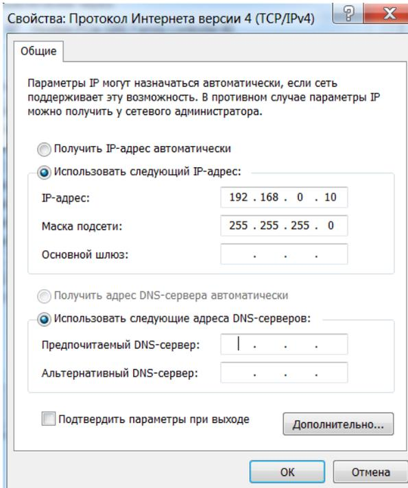
По умолчанию IP адрес коммутатора **192.168.0.1** Вы можете задать любой IP адрес в поле «IP адрес», в той же подсети что и IP адрес коммутатора. Нажмите кнопку ОК, чтобы сохранить и применить настройки.
