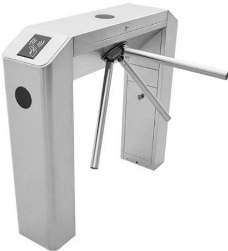
**TRASSIR TR-TP551** – тумбовый турникет-трипод из нержавеющей стали с функцией «антипаника». Обеспечивает санкционированный доступ на территорию охраняемого объекта. В устройстве предусмотрены LED-индикаторы направления прохода в обоих направлениях, место для установки двух считывателей карт или сканеров отпечатка пальца и контроллера доступа, вход для кнопки аварийной разблокировки. Турникет может использоваться с любой системой контроля доступа.
