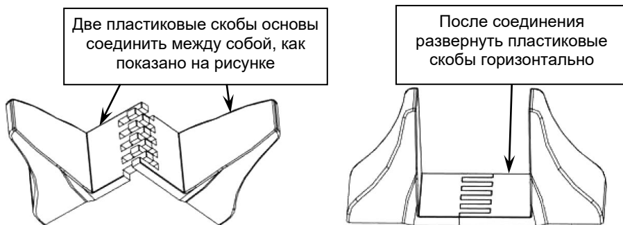
Рисунок 4 - Сборка пластиковых основ для вертикальной установки изделия.
