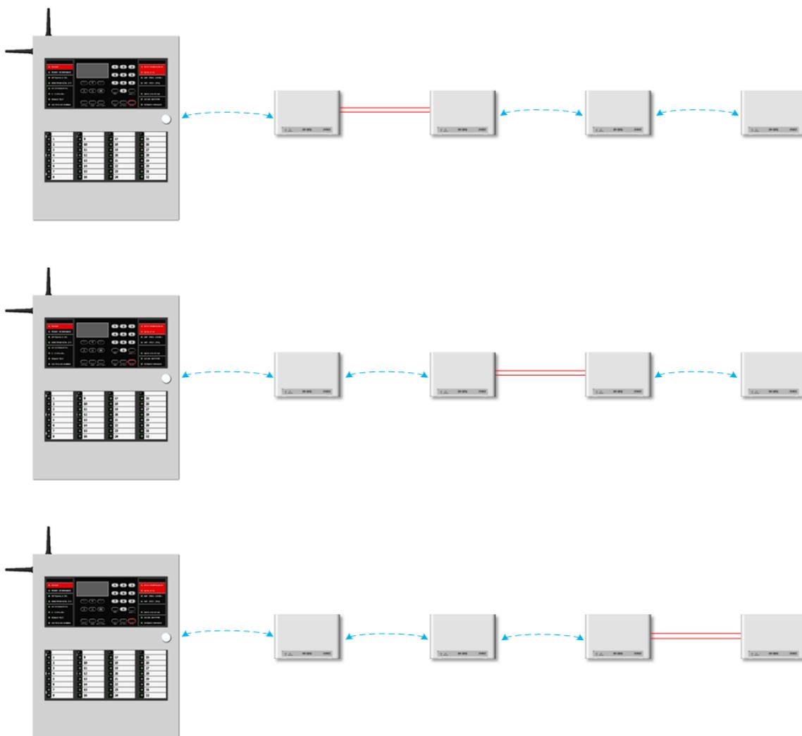
При потере связи по проводной линии, РР-ПРО-РТР автоматически переключится на связь по радиоканалу с другими РР.
