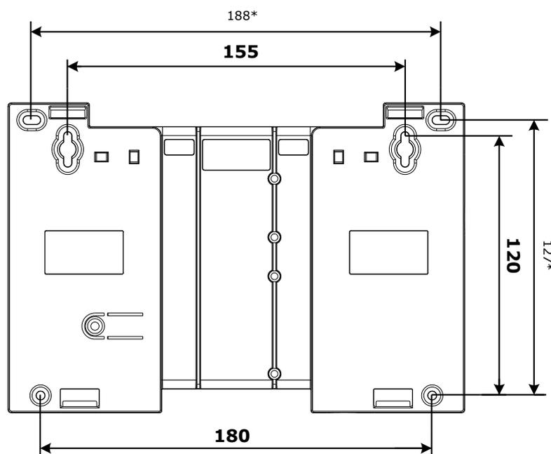
После навешивания контроллера в корпусах с IP41 он закрепляется на стене путём ввёртывания одного, либо двух дополнительных шурупов.
