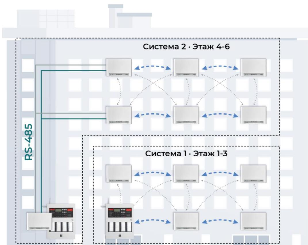
РР-ПРО-РТР также позволяет обеспечить связь между несколькими частями радиосистемы, разделенной массивными перекрытиями (подвалы, технические этажи и пр.).
