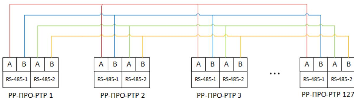
Для согласования линии применяются согласующие цепи, встроенные в каждое устройство. Для корректного функционирования необходимо вклю-
