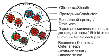
Рисунок 6 - Конструкция патч-кабеля категории 6A типа S/FTP / Figure 6 - Design of S/FTP patch cord of 6A category
