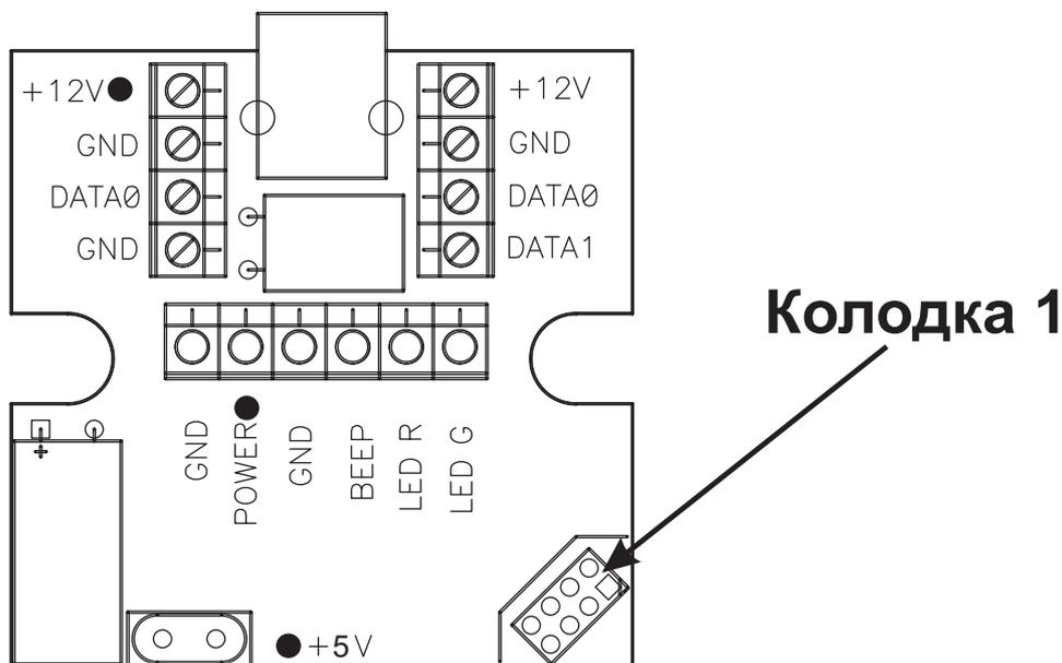
Ресурс контактов колодки ограничен и составляет 200 соединений. Рекомендуется сделать переходник или использовать это включение только в тех случаях, когда программирование контроллера через контакты DATA0 и GND невозможно.
