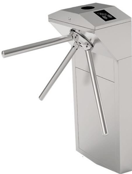
**TRASSIR TR-TT552** – турникет-трипод из нержавеющей стали с функцией «антипаника». Обеспечивает санкционированный доступ на территорию охраняемого объекта. В устройстве предусмотрены LED-индикаторы направления прохода в обоих направлениях, место для установки двух считывателей карт или сканеров отпечатка пальца и контроллера доступа, вход для кнопки аварийной разблокировки. Турникет может использоваться с любой системой контроля доступа.
