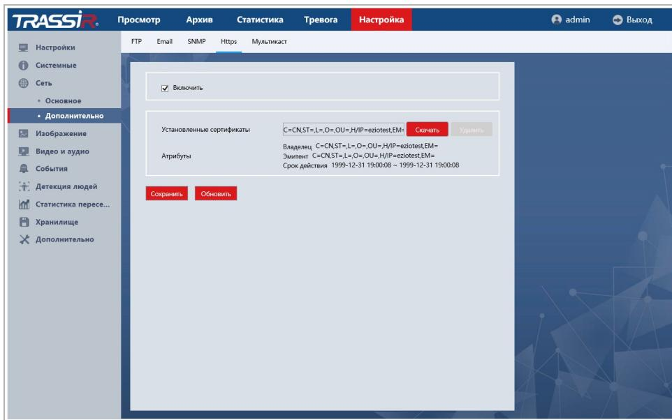
Установите флаг **Включить [Enable HTTPS]** для включения функции.
