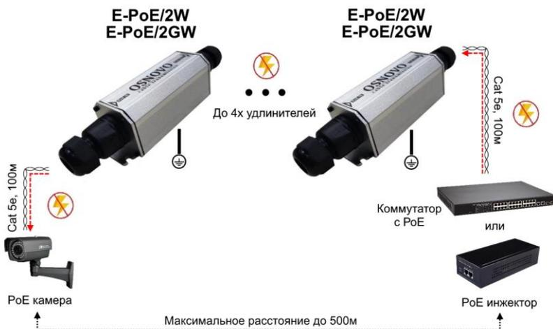
Рис.3 Схема подключения удлинителей E-PoE/2W, E-PoE/2GW
