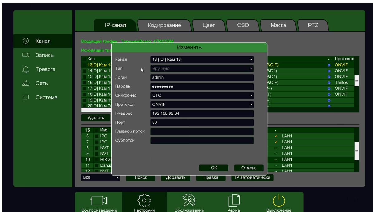
При успешном подключении в разделе **Статус** появится статус **Подключено** и будет показано разрешение основного видеопотока и субпотока.
