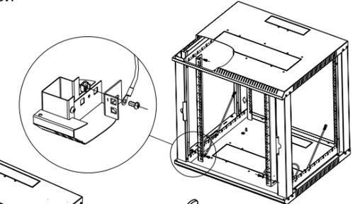
**5** Установите точечные замки в боковые стенки (D). Соедините провода заземления с ножевыми клеммами боковых стенок
