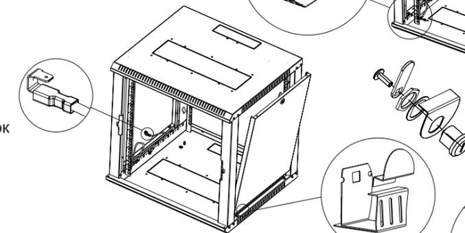
**6** Установите дверь (E). Предварительно установите петли (согласно определенной стороны открывания двери), точечный замок (аналогично с установкой в боковые стенки), демпфера. Соедините провод заземления с ножевой клеммой двери (аналогично с боковыми стенками).
