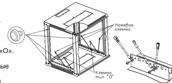
**4** Установите вертикальные направляющие (G) на необходимую глубину. Используйте винты М6х12 и гайки с фиксатором М6. В нижние соединения вертикальных направляющих закрепите провода заземления клемма «О»
