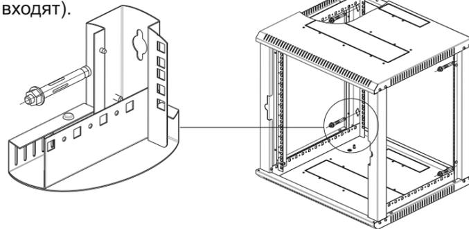
**Установка задней стенки шкафа.** Установите заднюю стенку и зафиксируйте при помощи четырех резьбоформирующих винтов (опция)
