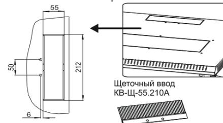
Возможна установка вентиляторного модуля R-FAN-2J, R-FAN-2T, R-FAN-3J, R-FAN-2T
