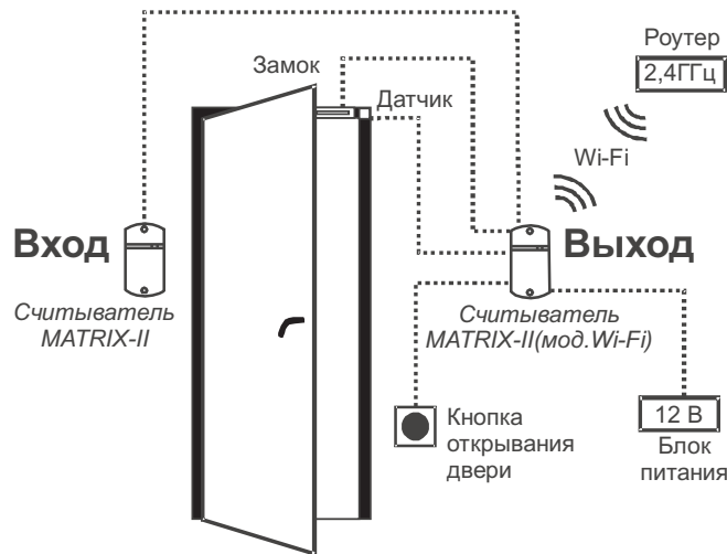
Рис.2 Схема подключения MATRIX-II (мод. Wi-Fi).
