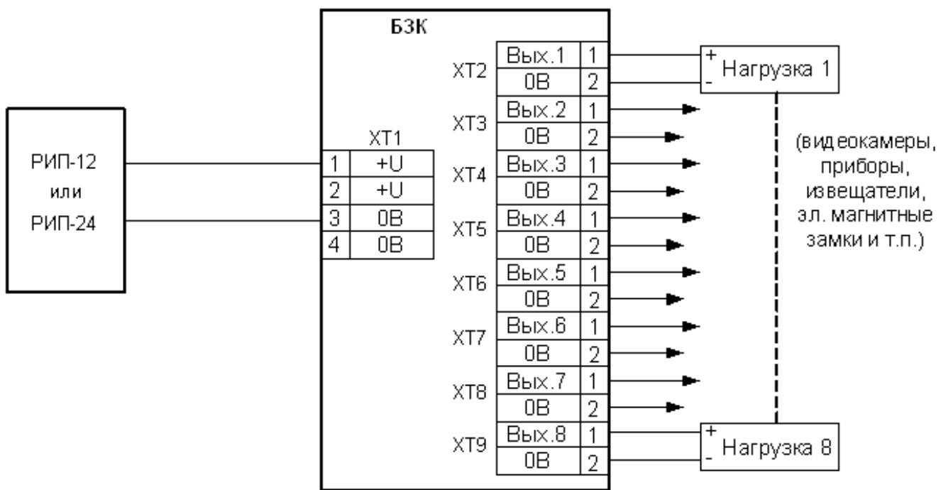
Схема параллельного подключения БЗК
